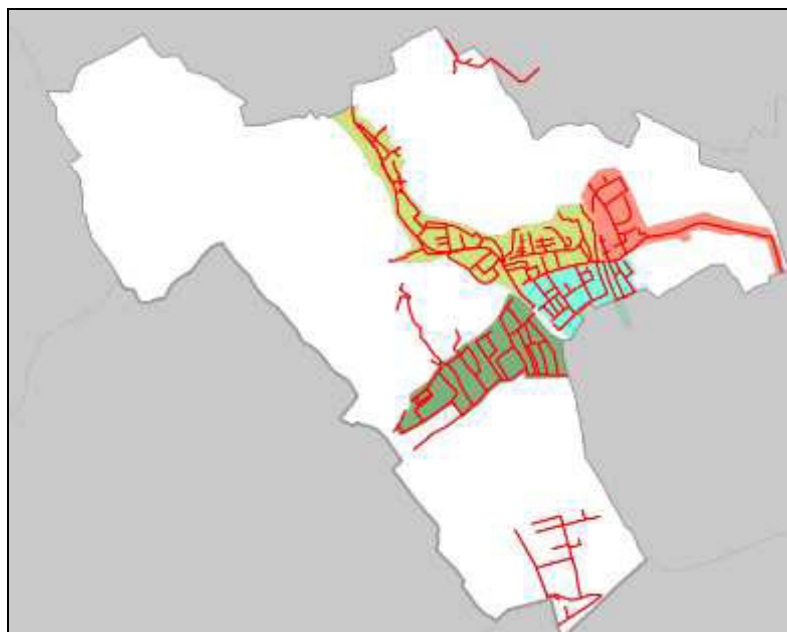
Le quattro aree in cui è stata schematizzata la rete di fognatura mista
