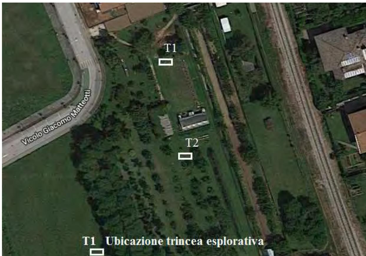
Fig.13 – Ortofoto dell’area con ubicazione delle trincee esplorative
